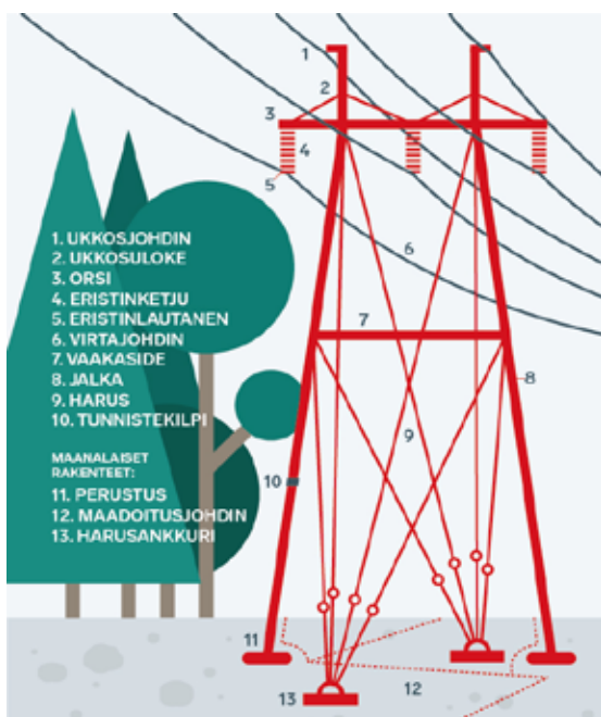
Kuva 2. Voimajohdon ja johtoalueen osat.
